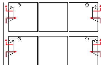
Aerazione con finestre ad apertura automatizzata
